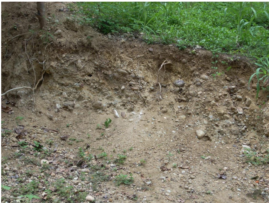
Figura 14. Arena y gravas angulosas de composición carbonatada, de centil 3-12 cm. Aspecto suelto y con un espesor escaso de 1 a 3 m. Edad Cuaternario. Clasificación geotécnica T-3. (afloramiento AF404).
