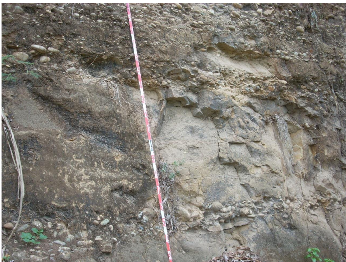
Figura 8. Fm. San Cristóbal. Arenas y gravas polimícticas subredondeadas y subangulosas de centil 8-10 cm. Aparecen niveles decimétricos de arena gruesa bien cementados. Dirección de buzamiento 140° buzamiento 8°. Clasificación geotécnica T-1 (afloramiento AF402).
