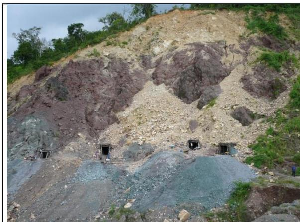
Foto 132: pequeñas galerías de explotación del larimar al contacto basaltos hidrotermalizados y debris flows rojizos; Mina de los Cheseses, Hoja de La Ciénaga (116MJ9181\_1; Lat: 18,11905607; Long: -71,14348481)
