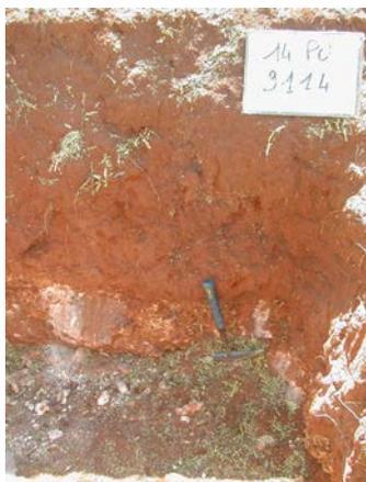
Foto 51: Pozo para cal, de 1.30 m, con 1m de arcillas y gravas rojizas suprayaciendo las calizas blancas desmanteladas – (14PU9114: Lat.: 19,59301; Long.: -71,32495)
