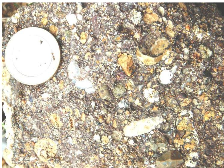
Fig. 35: Unidad de los conglomerados de Azlor – Foto de detalle de los conglomerados sideríticos con cantos polimicticos sub angulosos a redondos
