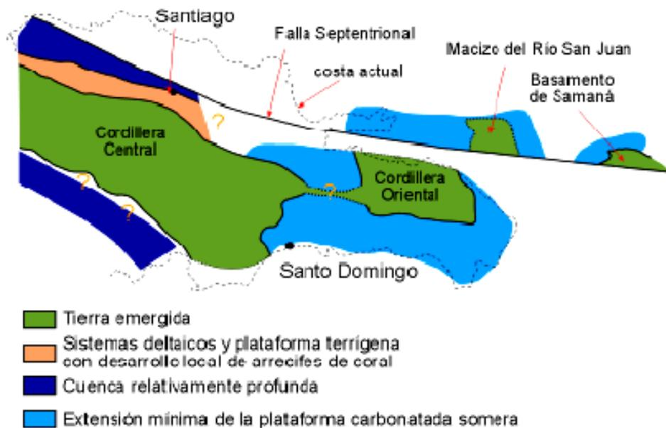
Figura 6.2. Esquema paleogeográfico de las plataformas marinas en La Española en el Plioceno. Este esquema recoge el desplazamiento mínimo de las plataformas de la Cordillera Septentrional y de la Península de Samaná a lo largo del sistema de fallas de la Falla Septentrional (Braga, 2010).
