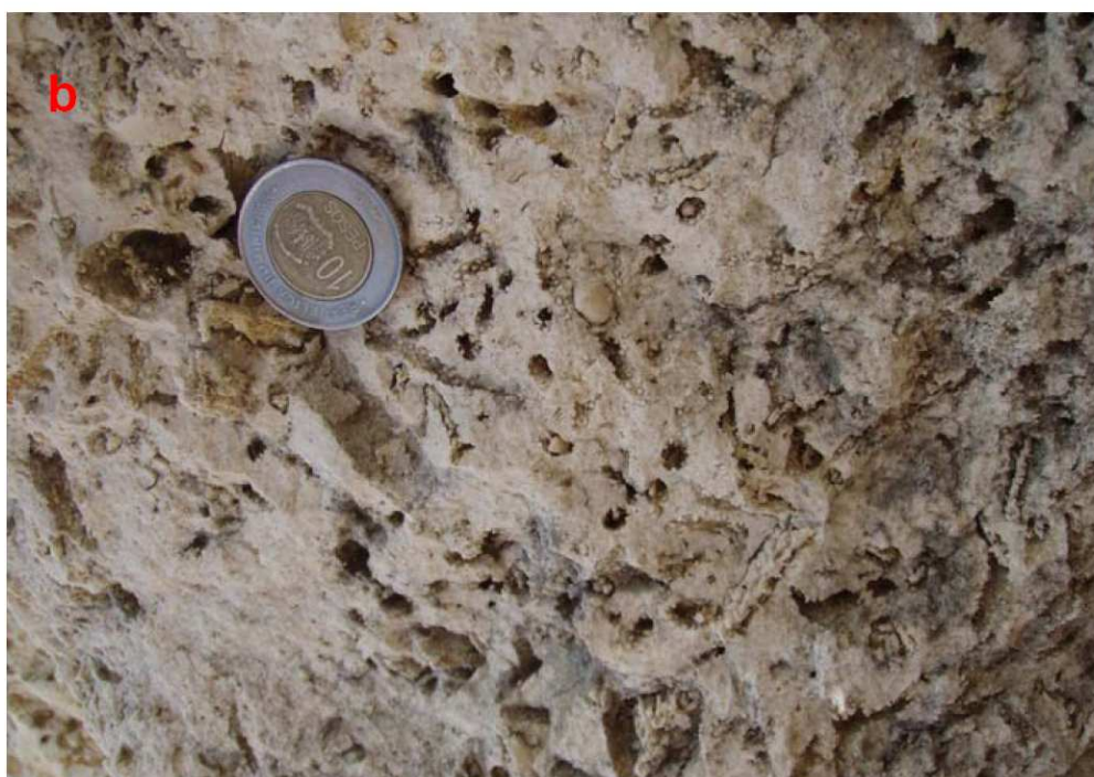
Foto 22: Diferentes tipos de corales en las calizas de Los Haitises (Ud Calizas arrecifales a: Acropora cervicornis , b: Stylophora sp. , Cantera de Higüey junto al río Chavón (Braga J.C., 2010).
