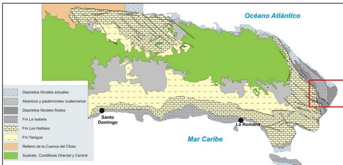
Fig. 1.6. Esquema geológico de las plataformas plio-cuaternarias del sector oriental de la República Dominicana
