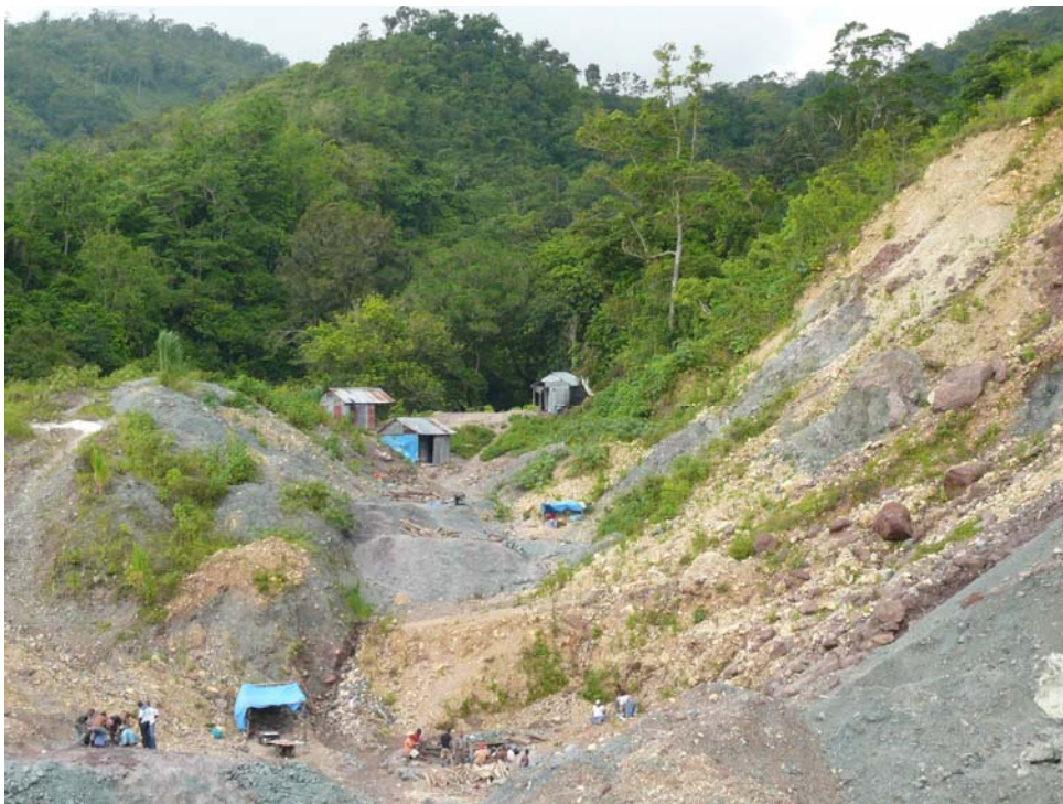
Foto 4.- Fuerte pendiente del flanco de la mina de larimar con bloques métricos de debris flow rojizos muy peligrosos; Mina de los Checheses.
