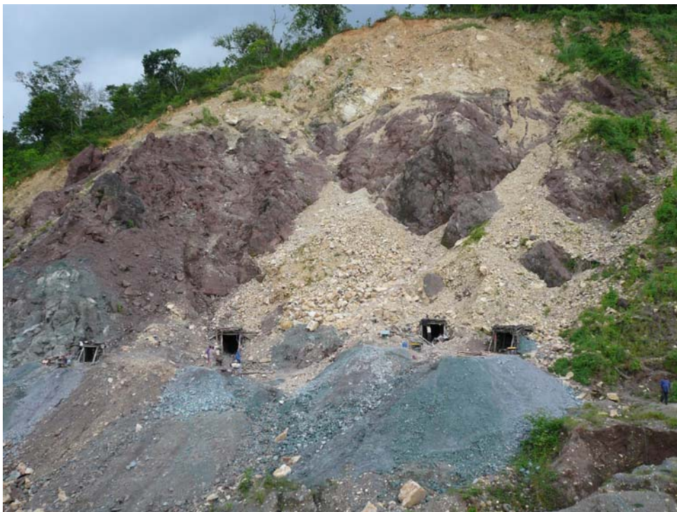
Foto 3.- Pequeñas galerías de explotación del larimar al contacto basaltos hidrotermalizados y debris flow rojizos; Mina de los Checheses, Hoja de La Ciénaga
