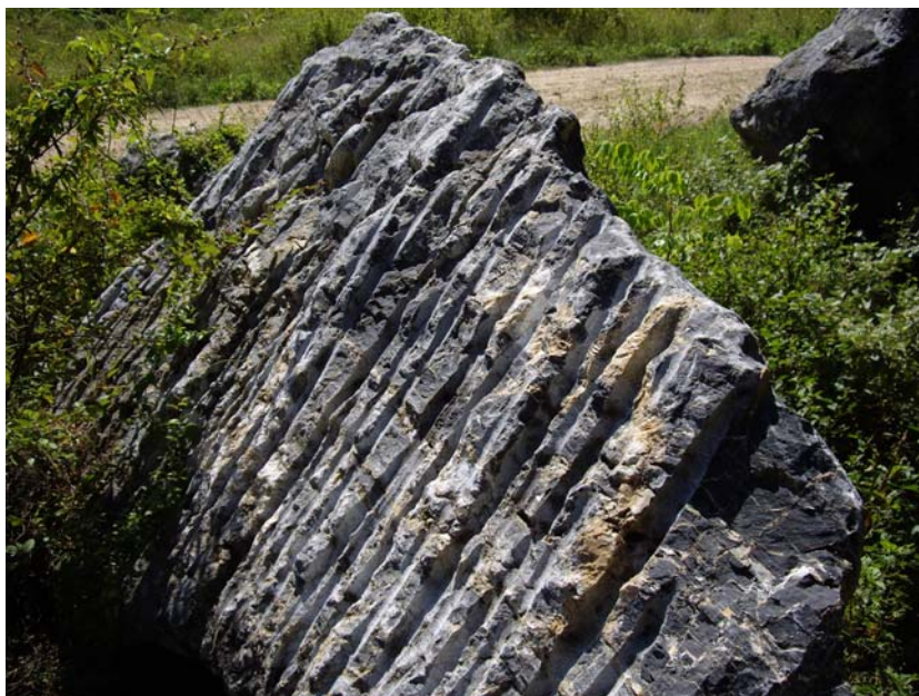
Foto 4. Bloque de mármol con las típicas huellas de hilo del arranque.
