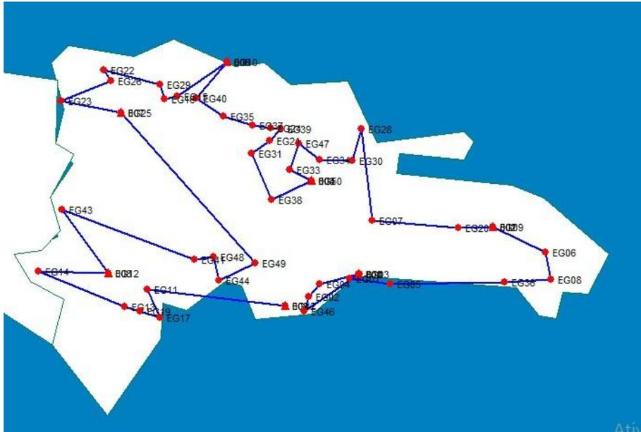
Figura 1 - Representación de Circuitos Gravimétricos (GRAVSUR)
