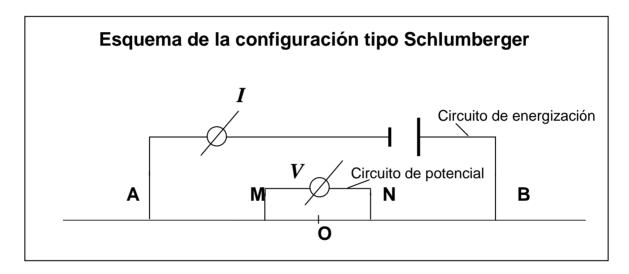
En los trabajos de campo, los parámetros que se miden son la intensidad de corriente I (poniendo un miliamperímetro en serie con el circuito de energización), la diferencia de potencial V (mediante un milivoltímetro puesto en paralelo al circuito de potencial) y las distancias entre los electrodos A, M, N, B utilizados.
