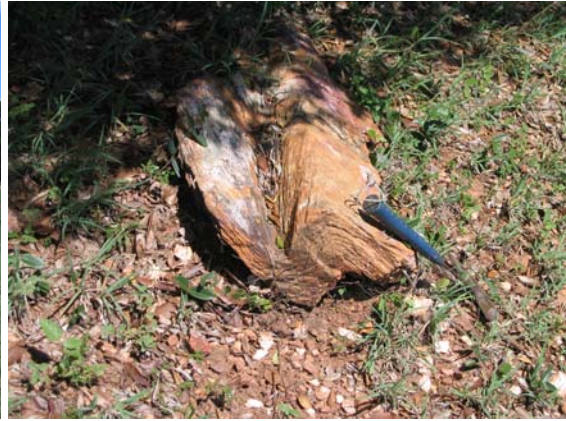
Foto 21. Rocas silicificadas y ferruginizadas en un pequeño gossan. Anomalías A y B. Foto 22. Anomalías A y B. Pliegue monoclinal esquistos sericitico ferruginizado.
