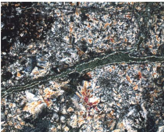
Foto 45. Indicio 13. Luz transmitida, 100X, NX. Masa de cristales prismáticos de epidota atravesados por una vena de malaquita. Foto 46. Indicio nº 13. Luz reflejada. 100X. NX. Vena de azurita.
