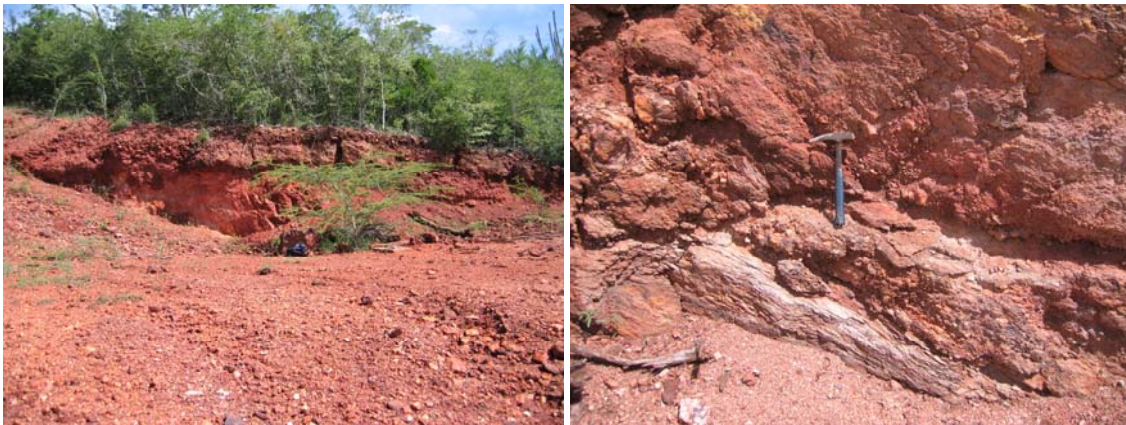
Foto 5. Cerro Verde. Gossan, posiblemente transportado, sobre esquistos sericíticos ferruginizados. Plaza de sondeo.
