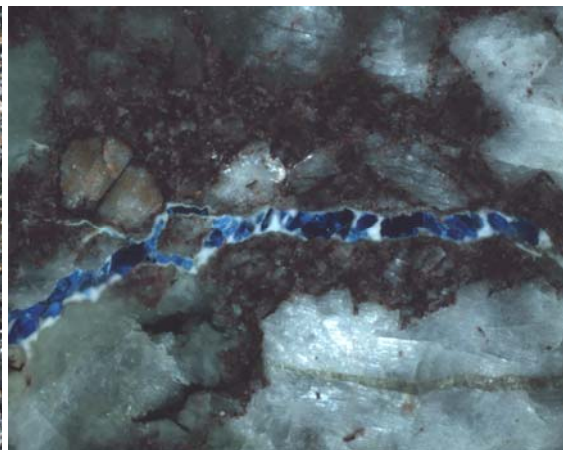
Foto 45. Indicio 13. Luz transmitida, 100X, NX. Masa de cristales prismáticos de epidota atravesados por una vena de malaquita. Foto 46. Indicio nº 13. Luz reflejada. 100X. NX. Vena de azurita.
