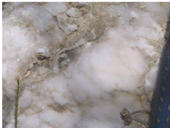
Fotos 21 y 22. Detalles de la apariencia del yeso en el indicio nº 9. Falta de homogeneidad y numerosas inclusiones de impurezas.
