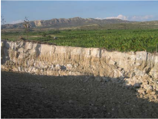
Fotos 6 y 7. Vista del frente de explotación actual. Buzamiento suave de la capa hacia el E y hundimiento bajo recubrimiento cuaternario (cultivo de plátano)
