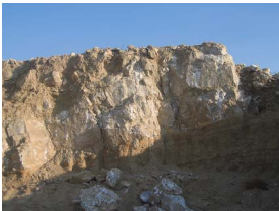
Fotos 4 y 5. Cantera de yeso de Los Manguitos (nº 5). Capa métrica de yeso en el frente de explotación. Laminación del nivel de arcillas inferior.
