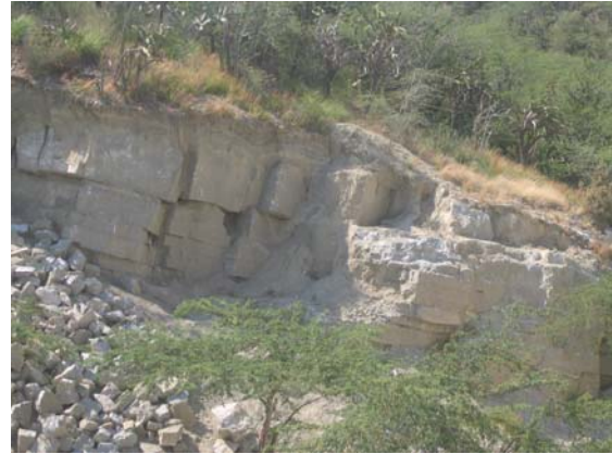
Foto 12 (izqda). Indicio de yeso nº 7. Labores de explotación de capas de yeso a ambos lados del arroyo Barranco (Loma del Yeso)
