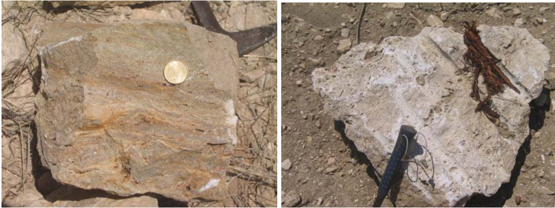
Foto 35. Indicio 16. Apariencia de una muestra de travertino. Estructura bandeada y oquedades. Foto 36. Apariencia de un bloque extraído en labores antiguas.
