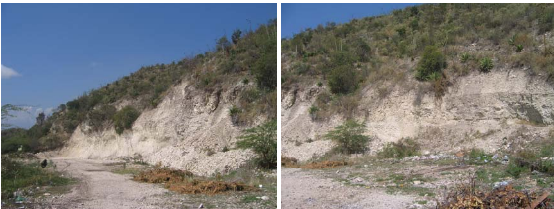
Foto 61. Indicio nº 6. Cantera de calizas en la Fm. Neiba. Foto 62. Indicio nº 6. Aspecto del frente de explotación. Calizas tableadas (10-20 cm) subhorizontales de la Fm. Neiba y, encima, recubrimiento de coluvión con fragmentos de caliza.
