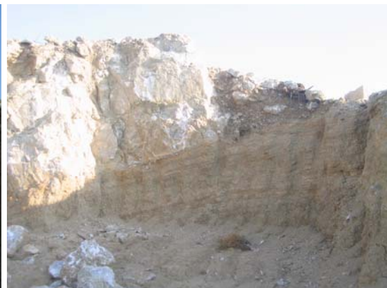
Fotos 4 y 5. Cantera de yeso de Los Manguitos (nº 5). Capa métrica de yeso en el frente de explotación. Laminación del nivel de arcillas inferior.
