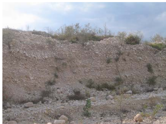
Fotos 50 y 51. Aspecto general de la explotación (al fondo, sierra de Neiba) y de detalle de un frente de la cantera de grava en depósitos aluviales cuaternarios. Indicio nº 11.
