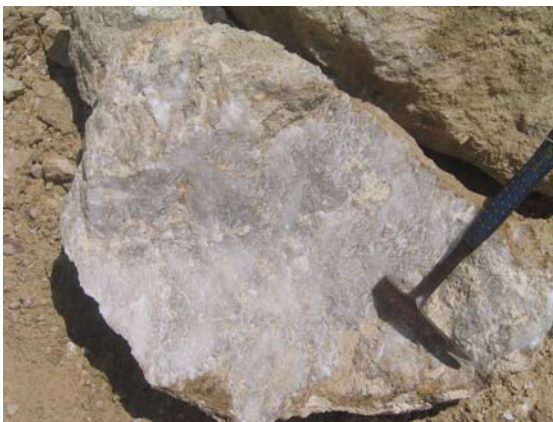
Fotos 21 y 22. Detalles de la apariencia del yeso en el indicio nº 9. Falta de homogeneidad y numerosas inclusiones de impurezas.
