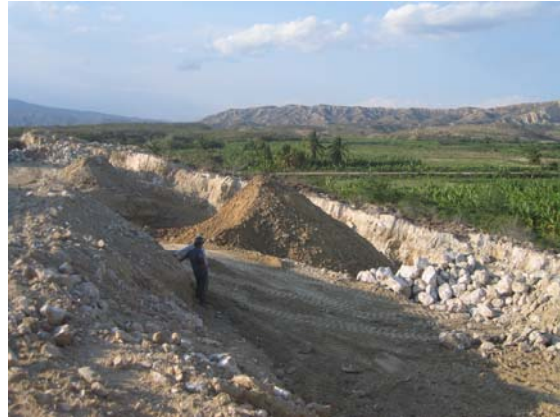
Fotos 6 y 7. Vista del frente de explotación actual. Buzamiento suave de la capa hacia el E y hundimiento bajo recubrimiento cuaternario (cultivo de plátano)
