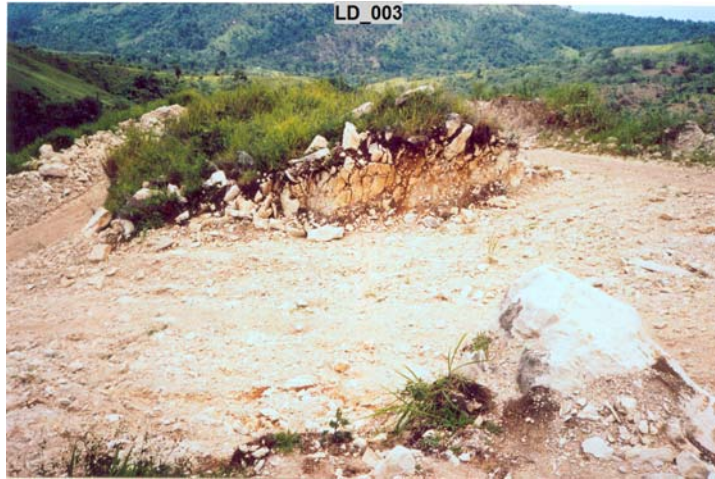
Foto 2. Vista de una pequeña explotación de calizas para áridos de machaqueo (nº 3)
