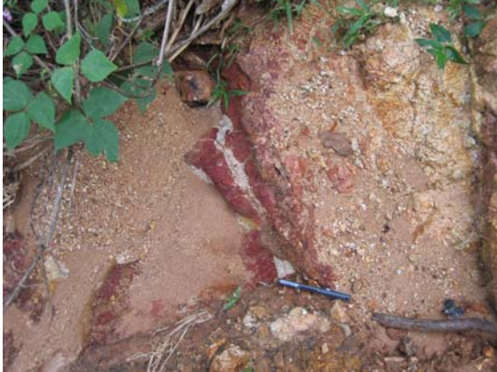
Fotos 1 y 2. Venas de cuarzo en afloramientos de rocas volcánicas alteradas (silicificación y argilitización) y ferruginizadas. Direcciones de las estructuras N70° y N45° respectivamente. Prospecto de Corozo. Indicio 1.
