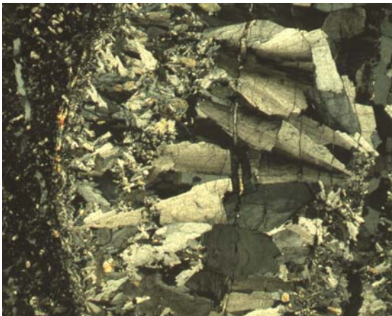
Foto 48. L.T. 50X. NX. Vena de cuarzo y epidota relleno de fractura extensional en roca piroclástica básica.
