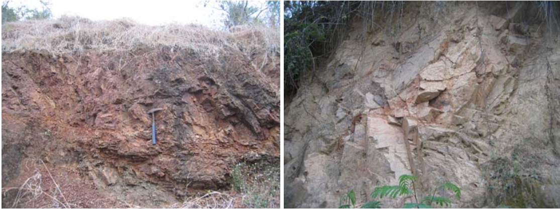
Foto 78. Cantera 11, de rocas epiclásticas básicas. Fracturación intensa y poca coherencia de los materiales.
