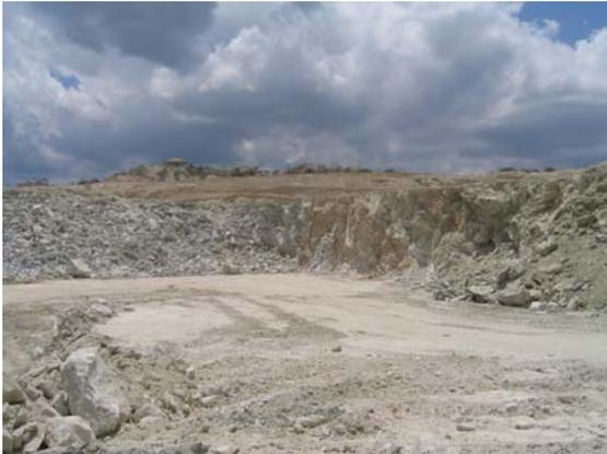
Foto 3. Mina de La Salina. Frentes de arranque de la explotación a cielo abierto. Bermas de 12 m.
